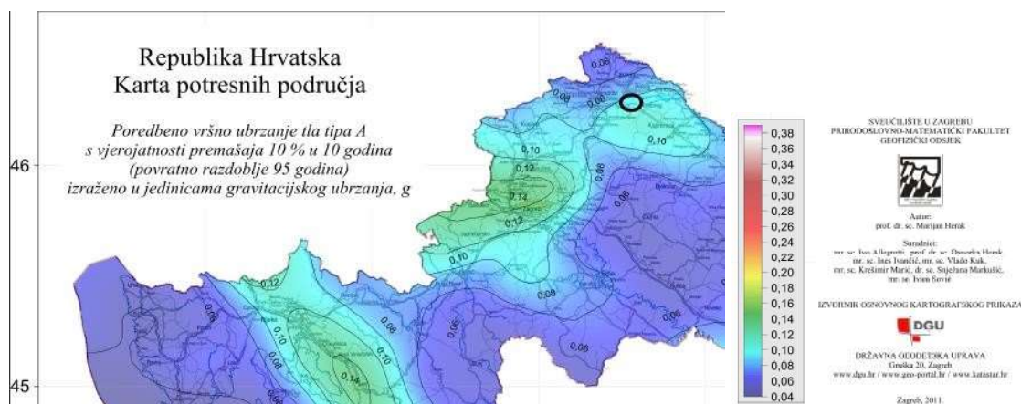
Slika 5: Izvod iz Karte potresnih područja u RH; Poredbeno vršno ubrzanje tla tipa A, povratno razdoblje 95 godina
