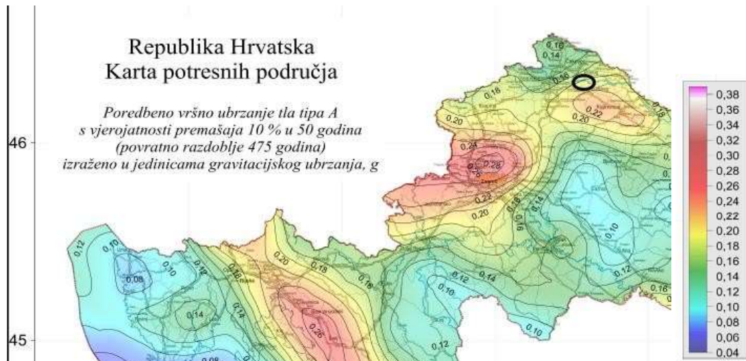
Slika 6: Izvod iz Karte potresnih područja u RH; Poredbeno vršno ubrzanje tla tipa A, povratno razdoblje 475 godina
